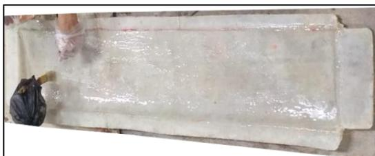
Gambar 9. Proses Pemolesan Resin Epoksi pada permukaan cetakan
