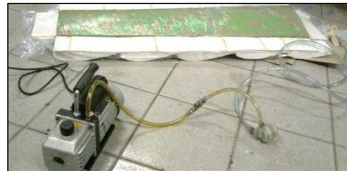
Gambar 7. Proses *Vacuum Bagging* pada Lapisan Pertama Pembuatan Cetakan Bagian Depan
