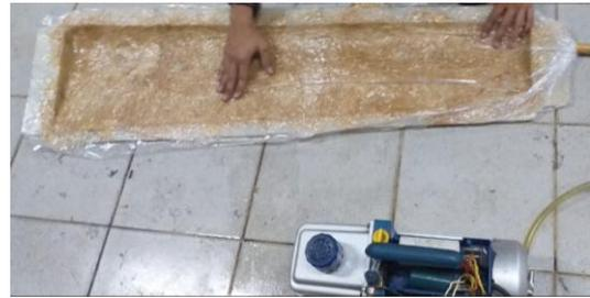
Gambar 10. Proses *vacuum bagging* dalam pembuatan bilah bagian depan.
