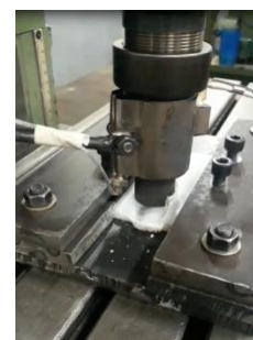
Gambar 2. Proses FSW material PE
