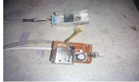
Gambar 3. Rangkaian Dc to Dc Konverter dan IC L7805CV
