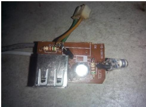
Gambar 2. Rangkaian Dc to Dc Konverter
