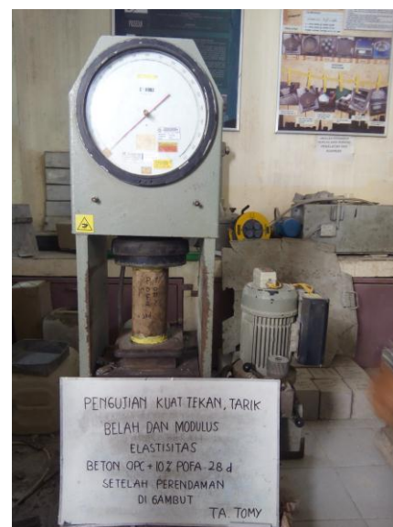
Gambar 3. Pengujian Kuat Tekan Sumber : Data Penelitian
