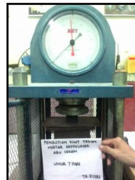
Gambar 2. Pengujian Kuat Tekan Mortar
