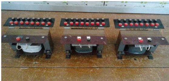
Gambar 14. 3 buah transformator satu fasa setelah dirakit
