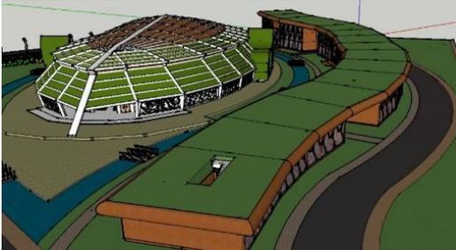
Gambar 3.12 Aplikasi *Green Roof* Pada Atap Bangunan Pendukung
