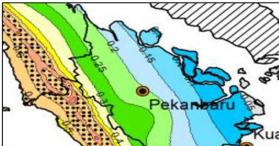
Gambar 6. Percepatan Tanah Puncak (SNI 1727-2013)
