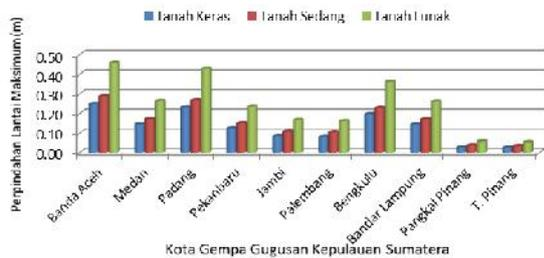
Gambar 4. Percepatan Lantai Maksimum Arah Y Kepulauan Sumatera
