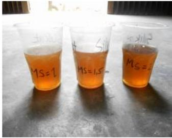
Gambar 2. Larutan Alkali Aktivator
