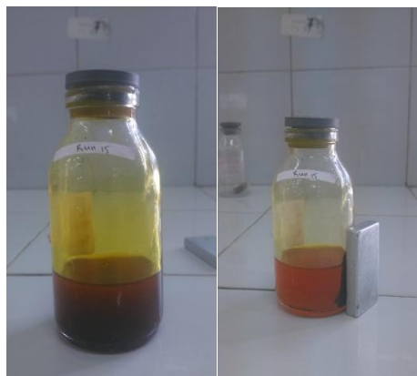
Gambar 1 Pemisahan Katalis \text{Ca}_2\text{Fe}_2\text{O}_5 Menggunakan Magnet
