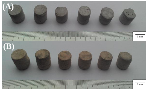
Gambar 1. (a) green bodies yang dihasilkan sebelum proses sintering (b) sintered bodies yang dihasilkan setelah proses sintering
