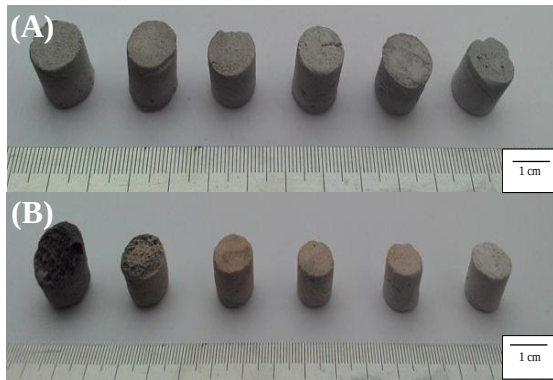
Gambar 5. (a) green bodies yang dihasilkan sebelum proses sintering (b) sintered bodies yang dihasilkan setelah proses sintering
