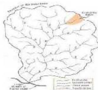
Gambar 1. Penentuan orde sungai dengan metode Strahler (1957)
