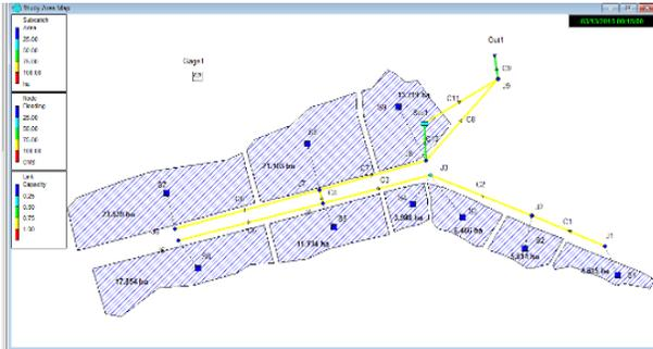
Gambar 6 Hasil *running* Model SWMM untuk skematisasi sistem drainase dengan penambahan kolam retensi Pada waktu 15 menit
