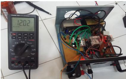
Gambar 8 Pengujian tanpa beban catu daya utama 12 V
