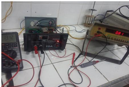
Gambar 19 Pengujian *charger* baterai berbeban
