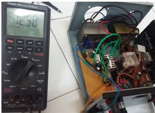
Gambar 13 Pengujian catu daya utama berbeban 12 V
