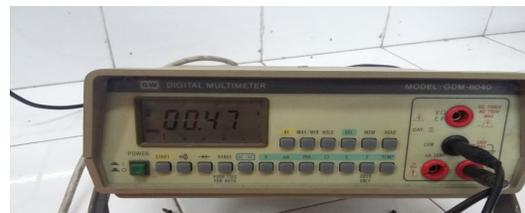
Gambar 15 Pengujian arus keluaran catu daya berbeban 12 V
