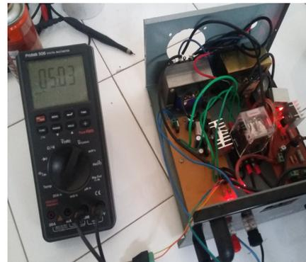
Gambar 10 Pengujian berbeban catu daya utama 5 V
