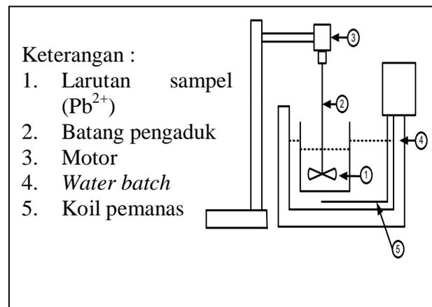
Gambar 2.1 Rangkaian Alat Adsorpsi
