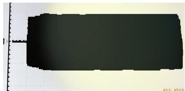
Gambar 4.12 Tegangan motor induksi tiga fasa saat *starting*
