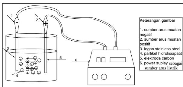
**Gambar 2. Rangkaian alat deposisi elektroforesis**
