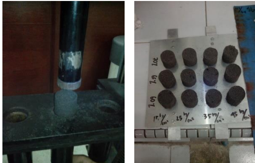
Gambar 3.1 Hasil Cetakan Briket dengan Mesh 50 dan Perekat 60, 65 dan 70%
