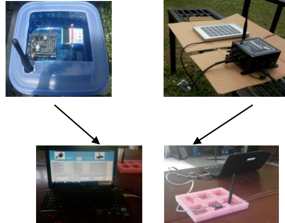
Gambar 21 Bentuk Topologi Star Perangkat Wireless Sensor Network Waspmote
