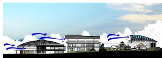
Gambar 10. Aliran Udara ke Dalam Bangunan
