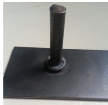
Gambar 3. Produk Bar-plate hasil pengelasan gesek
