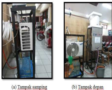
Gambar 4 Alat Penggunaan Evaporative Cooling Pada AC Split 1 PK.
