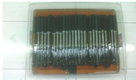
Gambar 7. Hasil akhir proses pembubutan 100 spesimen
