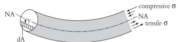
Gambar 2. Skematik tegangan yang terjadi pada *positive bending*[4]
