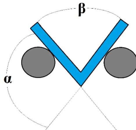
Gambar 1. Parameter sudut pembungkakan[17]
