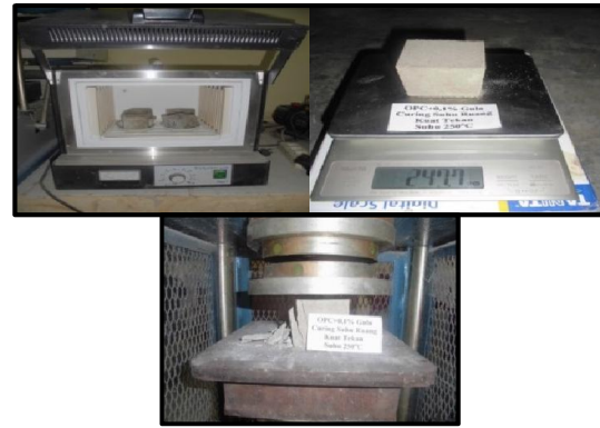
Gambar 3. Pengujian kuat tekan
