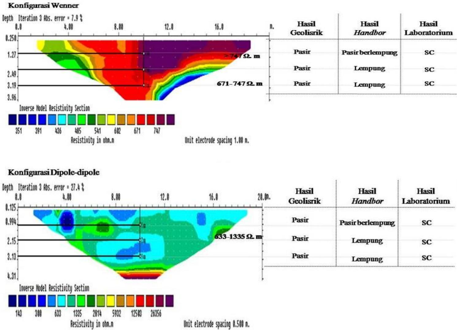
Gambar 3 Hasil Pengujian Geolistrik, *Handbor*, dan Laboratorium Lokasi Halaman Kampus UR Gobah pada Line 1
