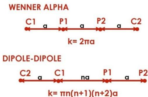
Gambar 1 Dua Jenis Konfigurasi Yang Digunakan dalam Pengujian Resistivitas
