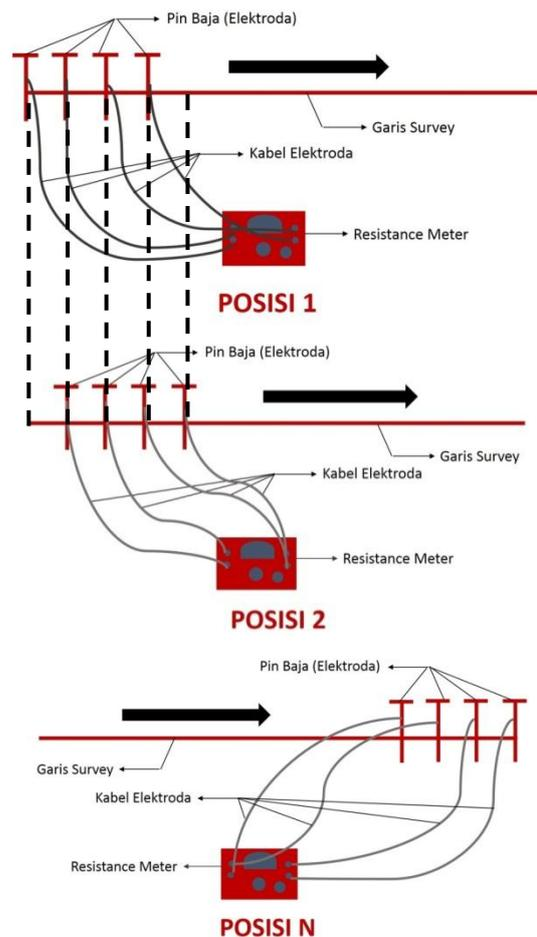
Gambar 2 Ilustrasi Contoh Perpindahan Posisi Elektroda
