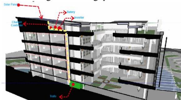
Gambar 2. Skematik Penempatan Solar Panel
