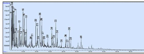
Gambar 8. Kromatogram *bio-oil* pada persentase pengembunan 6% Ni/NZA
