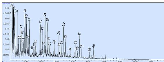
Gambar 7. Kromatogram *bio-oil* pada persentase pengembunan 3% Ni/NZA
