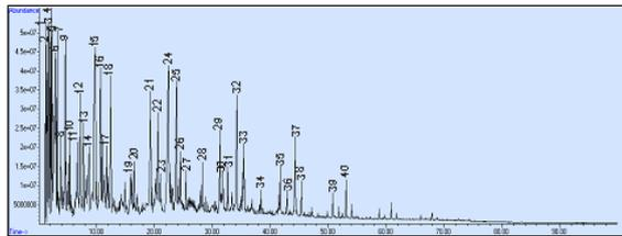
Gambar 6. Kromatogram *bio-oil* pada persentase pengembunan 1% Ni/NZA
