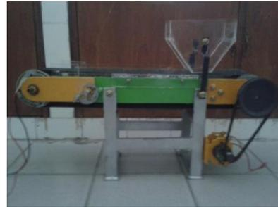
Gambar 4.1 Prototipe mesin pemisah sampah material ferromagnetik dan non ferromagnetik.
