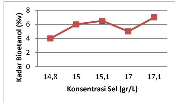
Gambar 4. Kurva Hubungan Kadar Bioetanol (%v) dan Konsentrasi Sel (gr/L)
