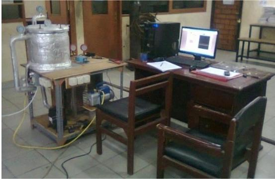
Gambar 10. Mesin Pengering Beku Vakum
