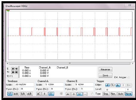
Gambar 11. Gelombang Keluaran Detektor fasa menggunakan satu motor dan satu kapasitor
