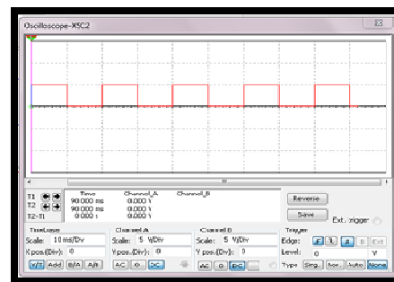
Gambar 10. Gelombang Keluaran Detektor Fasa Tanpa Beban Dan Tanpa Kapasitor
