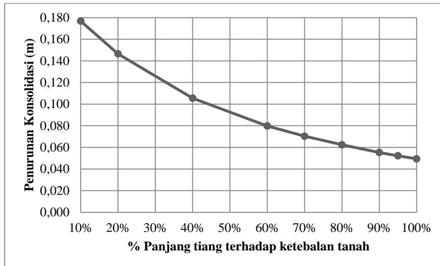
Gambar 5 Hubungan Penurunan Konsolidasi dengan Persentase Panjang Tiang terhadap Ketebalan Tanah
