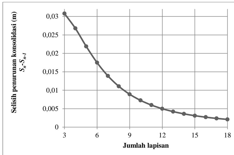
Gambar 4. Hubungan Selisih *Consolidation Settlement* dengan Jumlah Lapisan Tanah
