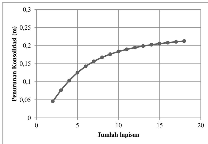
Gambar 3. Hubungan Besarnya Penurunan Konsolidasi dengan Jumlah Lapisan Tanah
