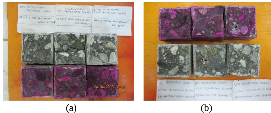
Gambar 11. Hasil pengujian penetrasi asam beton; (a) umur 7 hari rendaman, (b) umur 91 hari rendaman
