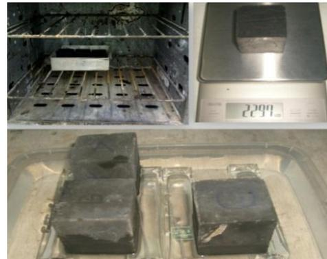
Gambar 2. Pengujian *Sorptivity*
