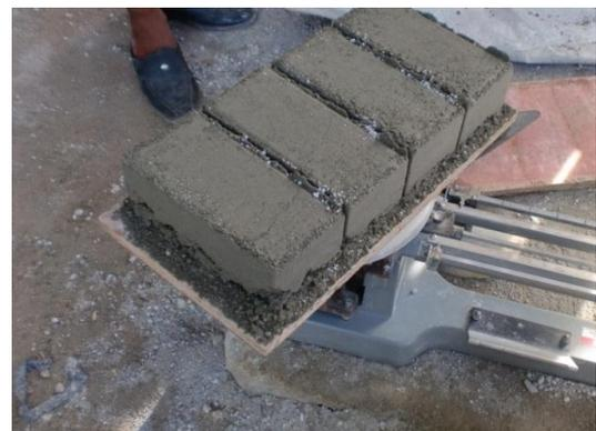
Gambar 1. *Paving block* dengan kadar air 5,55%
