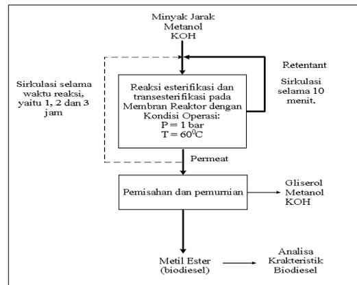
**Gambar 2.** Skema Pembuatan Biodiesel dari Minyak Jarak.
