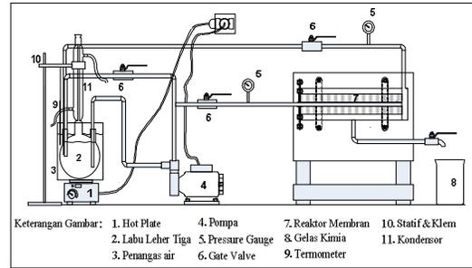
**Gambar 1.** Rangkaian Alat Membran Reaktor. (Syarfi dan Nazaruddin, 2010).
