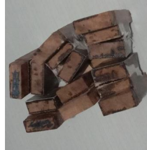
Gambar 15 Model Kerusakan Pengujian Kuat Geser
