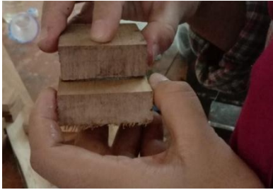
Gambar 10 Perekatan Benda Uji
