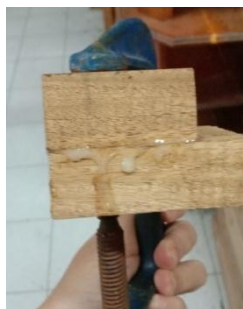
Gambar 11 pengempaan Benda Uji
