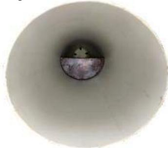
Gambar 4. Pipa Kondisi Sumbatan
