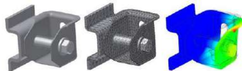
Gambar 5. Stress Analysis pada Autodesk Inventor [9]
