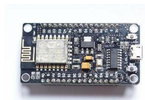
Gambar 1. NodeMCU ESP8266
