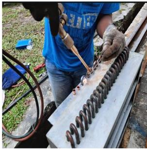
Gambar 4. Pembuatan kondenser
