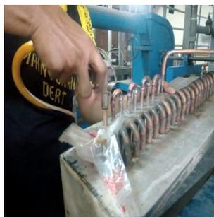
Gambar 5. Pengecekan kebocoran
