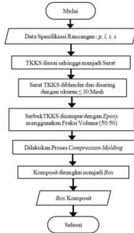
Gambar 7 Diagram Alir Pembuatan Box Komposit
