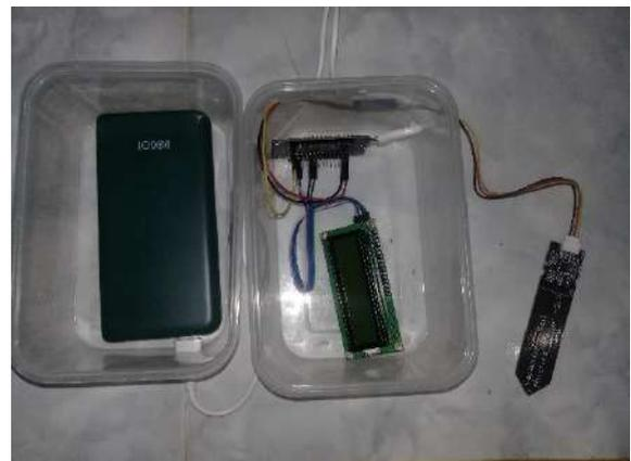
**Gambar 5.** Rangkaian perangkat monitoring kondisi tanah
