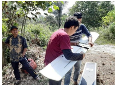
Gambar 11. Perakitan UAV fixed wing
