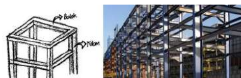
Gambar 4.31 Kolom dan Balok
