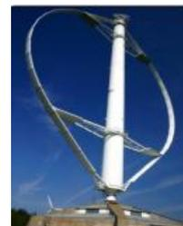
Gambar 3. Turbin Angin Sumbu Vertikal [6]
