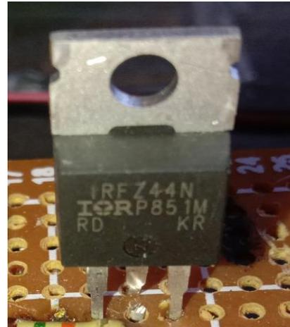
Gambar 5 Gambar mosfet tipe IRF44N
