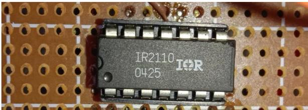
Gambar 4 Gambar *driver* mosfet IC IR2110
