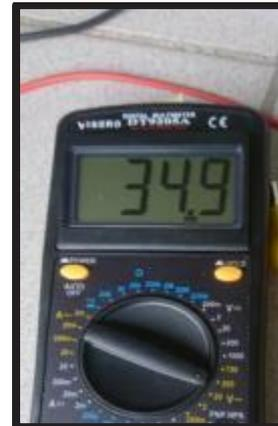
**Gambar 13** Pengukuran Tegangan keluaran PV Array 9 x 10 Wp Satu String Terkena *Shading* Setelah Inverter
