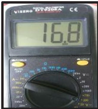
**Gambar 16** Pengukuran Tegangan keluaran PV Array 9 x 10 Wp Dua String Terkena *Shading* Setelah Inverter
