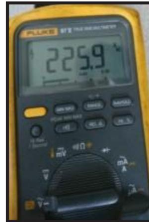
**Gambar 12** Pengukuran Tegangan Keluran Trafo Keadaan Tanpa *Shading*
