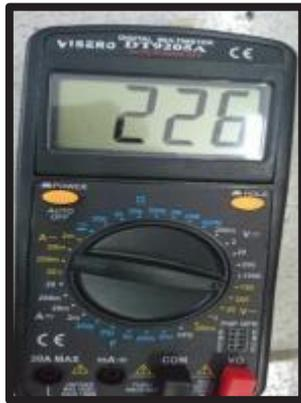
**Gambar 15** Pengukuran Tegangan Keluran Trafo Keadaan Satu String Terkena *Shading*
