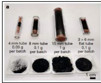
Gambar 2. Produksi Graphene Menggunakan Teknik Flash Graphene (FG) [2]
