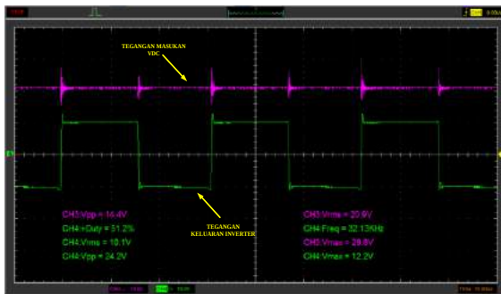
Gambar 13. Gelombang Tegangan Keluaran Inverter Half-Bridge
